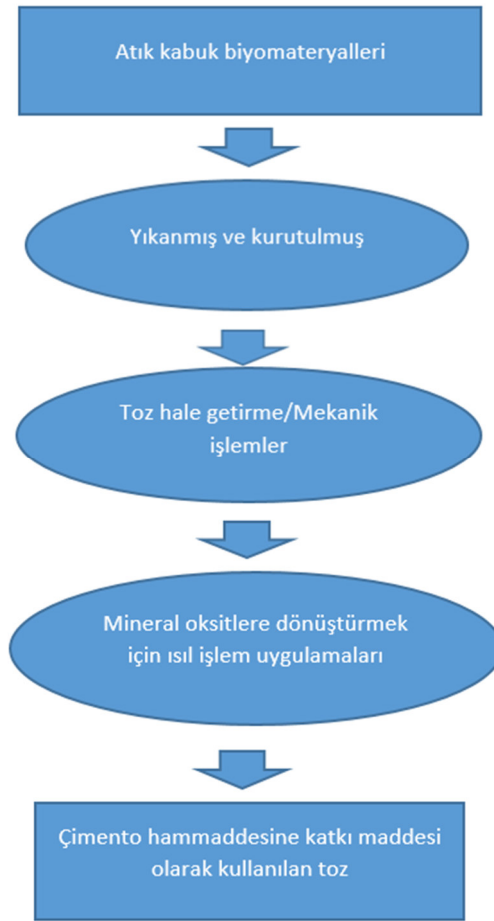
Şekil 2. Çimento Üretiminde Katkı Maddesi Olarak Kullanılan Atık Kabukların Metodolojisi
