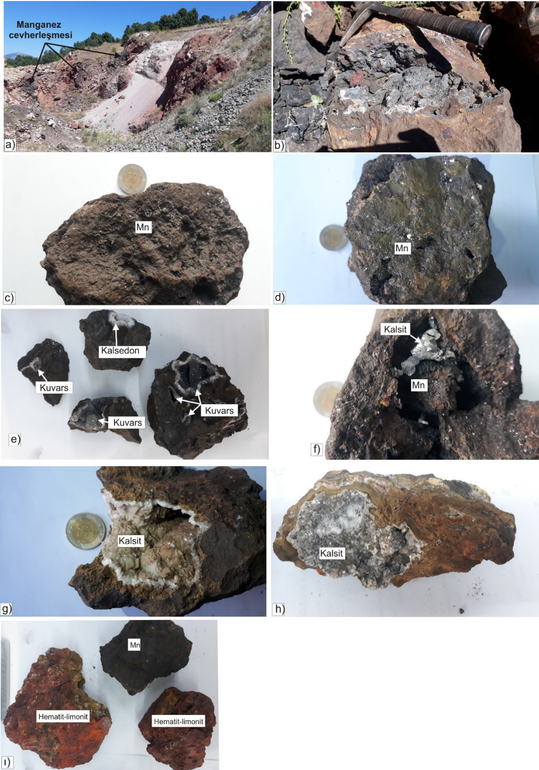
Şekil 5 a,b) Iısu manganez cevherleşmesi saha görünümü, c,d) manganez cevherleşmesi el örnekleri, e) manganez cevheri boşluklarında gelişmiş kristalin kuvars ve kalsedon oluşumları, f-h) manganez cevheri boşluklarında gelişmiş kalsit mineralleri, i) hematit-limonit-manganez oluşumları
